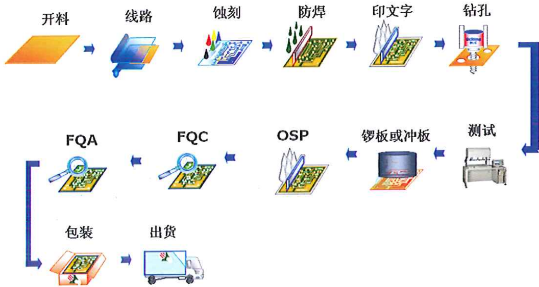
图 2.4-4 金属基线路板生产工艺流程示意图
